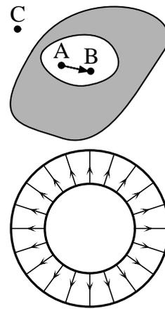
問 3\*(導体球殻) 中心を共有する半径  $a$  および半径  $b$  の導体球殻がある ( $b > a$  とする). この二つの導体のあいだに右図に示すような電気力線が生じており, それ以外の場所では電場はゼロであるとするとき以下の問いに答えよ.
