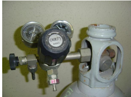
窒素ガス（等の一般ガス）用：右ネジ
