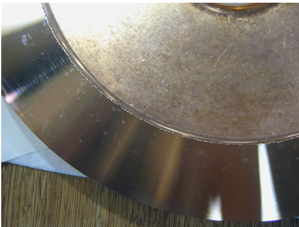
図 2-3 ロー付け試験体表面を 2mm 加工した状況 (図 2-1、2-2 に示す部分と異なる部分、裏面)
