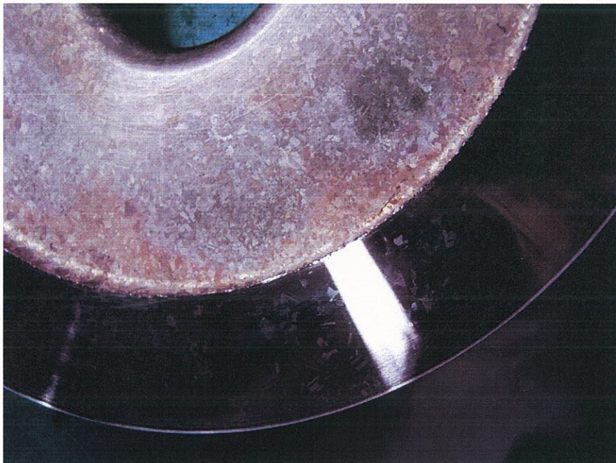
図 2-1 ロウ付け試験体表面を 3mm 加工した状態 (本体部(C1020)及び外筒部(C1011)に銅の結果粒が見える)
