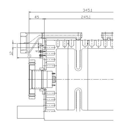
空洞部分への荷重を回避するために、肉厚部で支持するような治具を準備
