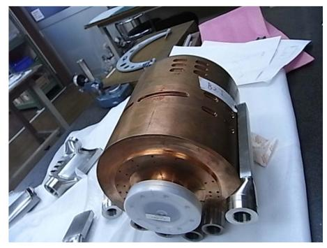
冷却管はめあい部の修正加工終了 ロウ付けへ移行
