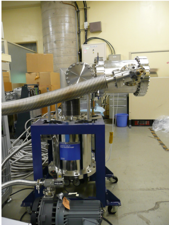
1回目の構成。ICF114バルブ、1mベローを介してTMPに接続。コンダクタンス10 L/s程度。
