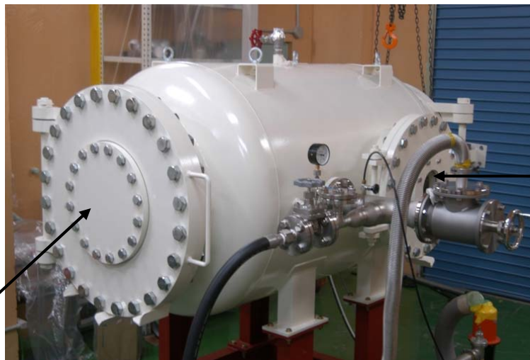
SF6ガスタンク
