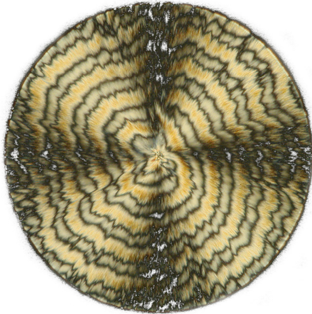
ポリヒドロキシ酪酸 偏光顕微鏡像
