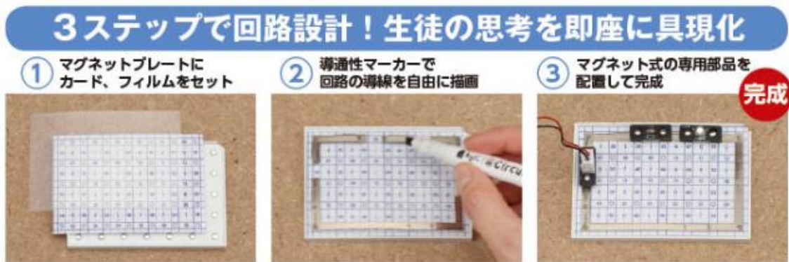
図3 回路の設計手順 (山崎教育システムカタログより)
