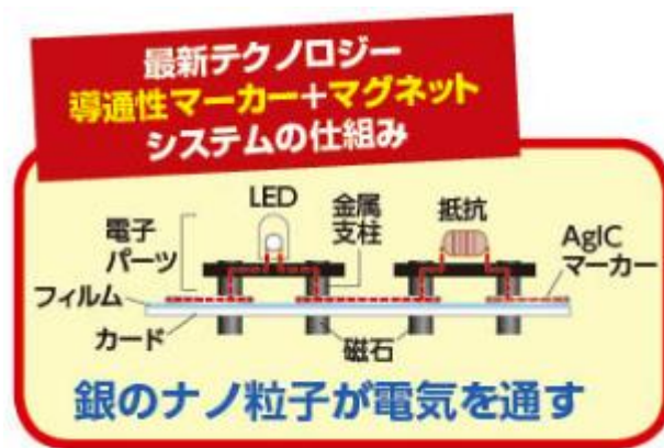
図4 電気の流れのしくみ (山崎教育システムカタログより)
