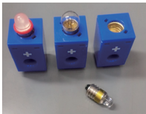
図 2 LED ユニットと電球
