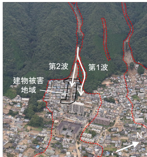
図 5 阿武の里団地における土石流の挙動と建物被害地域
