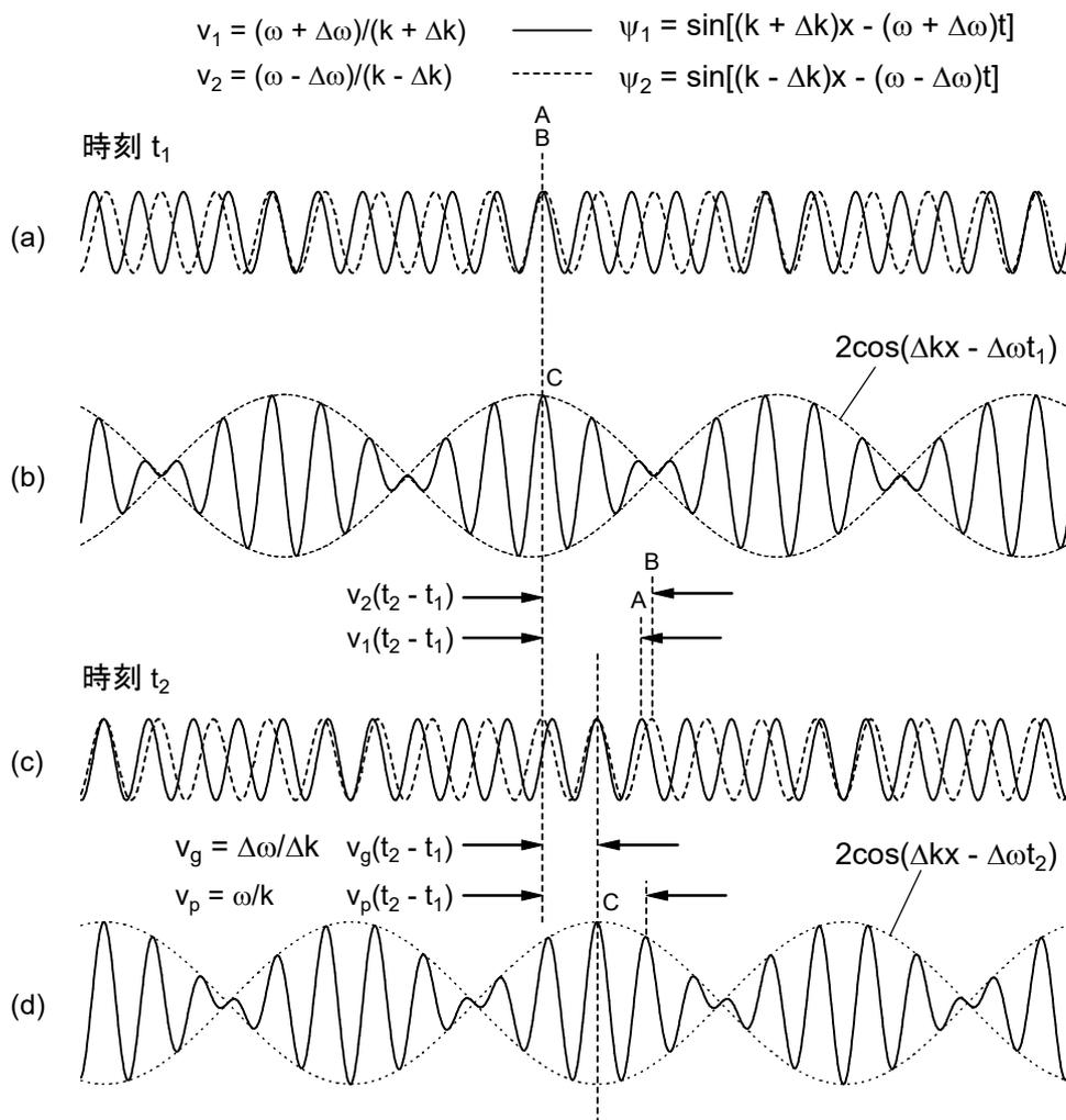
図1. (a) 時刻  $t_1$  での2つの carrier wave. (b) 時刻  $t_1$  での modulation envelope. (c) 時刻  $t_2$  での2つの carrier wave. A, B は(a)での A, B からの移動位置を表す。(d) 時刻  $t_2$  での modulation envelope. C は(b)での C からの移動位置を表す。
