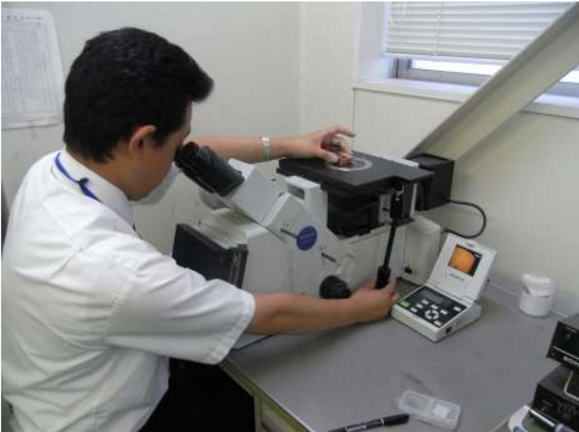
外筒ロー付け試験片断面の写真撮影の状況
