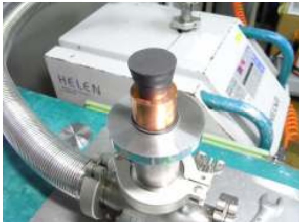
試験体のリーク試験のセッティング
