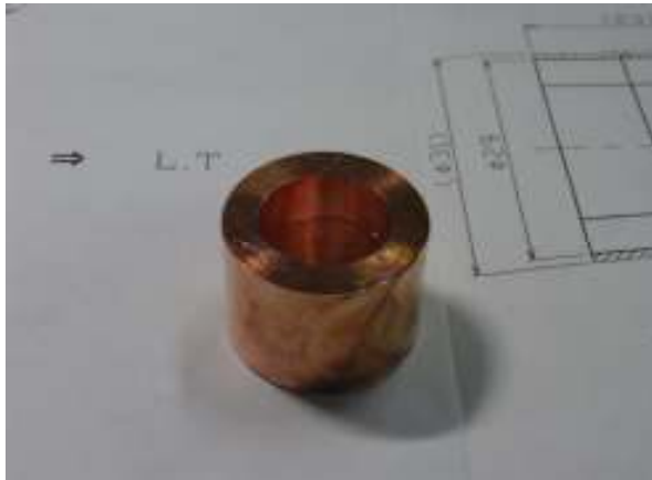
φ31まで切削後の試験体の外観
