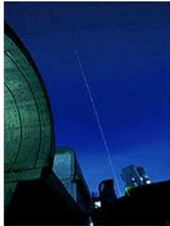
ライダー:レーザー光を用いたレーダーで上空を通過する黄砂をリアルタイムで計測する機器
