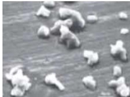
一般的に排ガスなどの粒子状の大気汚染物質は球形だが、黄砂粒子は球形ではない。この形状の違いをライダーは判別できるため、肉眼では区別できない黄砂と黄砂以外の大気汚染物質等の粒子状物質を判別して観測することが可能となる。
