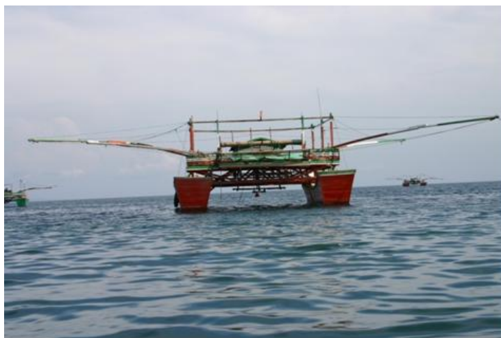
(写真10)インドネシア・アチェ周辺のカタクチイワシ漁に用いられるバガン船 (曳き船タイプ)
